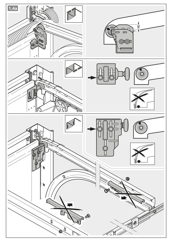
3. Pour les portes sectionnelles à serrure centrale, montez la pièce articulée de linteau et la cornière d'entraînement de manière excentrée (max. 500 mm).
