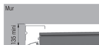
Disposition C : effacement derrière linteau
